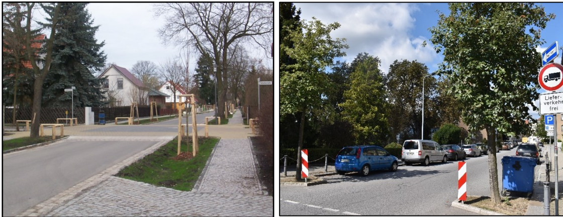
Abb. 73: Beispiele Plateauaufpflasterung / Baumtor (Erkner, BIW Bahnhofstraße)
