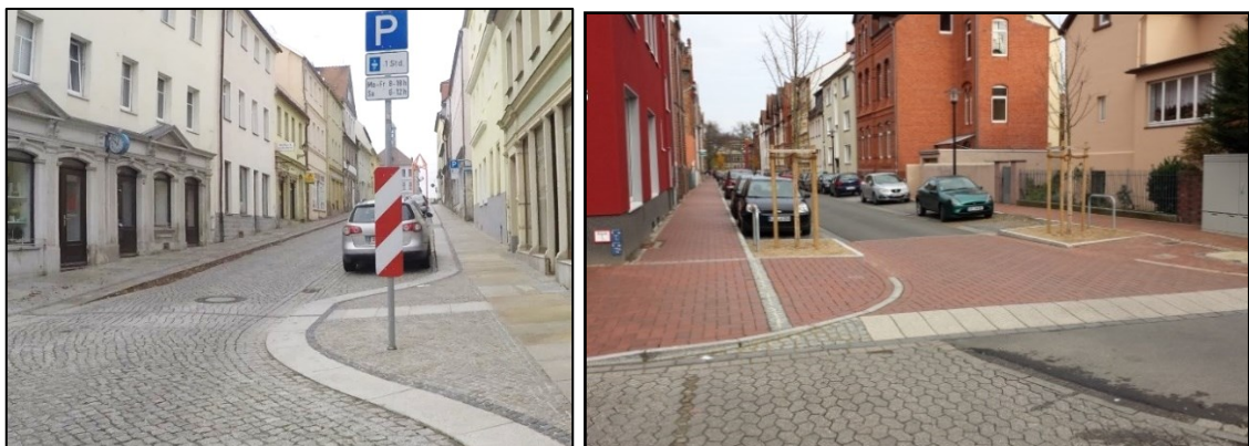
Abb. 79: Beispiel Gehwegvorstreckung bzw. Gehwegüberfahrt
